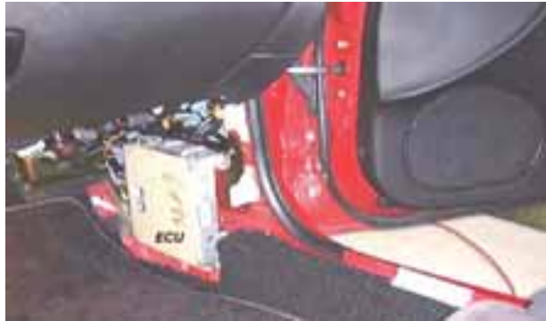
الشكل (٢٦) حاسوب تحت لوحة البيانات في المركبة
